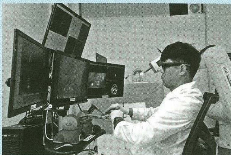
그림 6 정밀한 뇌수술 시 수술자를 도와줄 뇌수술 로봇을 연구진이 실시하고 있다. (자료: 전남대학교 로봇연구소)
